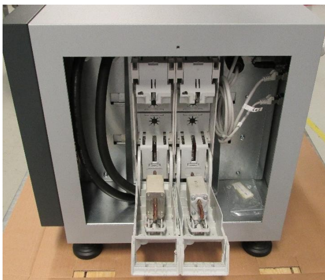
Obrázok 4-13: Systém skladovania batérií, bočný pohľad, odpojený oddeľovač napájania
