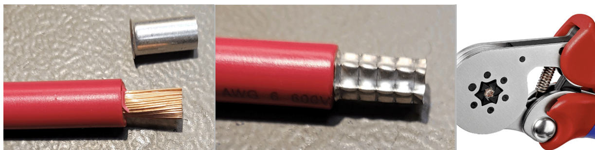
Šesťhranne krimpované očko s ochranou káblu (bootlace ferrule)
