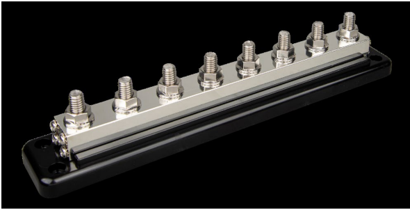
Bară colectoare 600 A cu 8 borne de curent mare și 8 borne cu șurub de curent mic, fără capac
