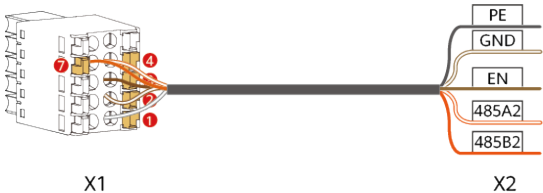
Abbildung 6-2 Signalkabel (vom Lieferanten gekauft, Typ 1) zwischen dem Akku und dem Wechselrichter
