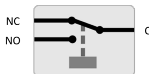
Configurarea releului (nealimentat).
