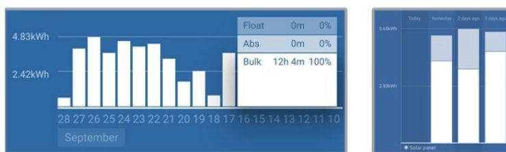
Sistemul petrece tot timpul în trafic masiv cu faze de încărcare divizate - Sistemul în trafic masiv și absorbție
