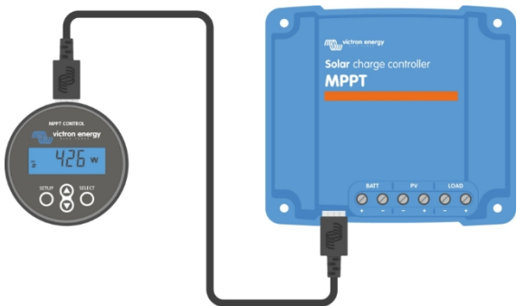
Conectați afișajul la încărcătorul solar printr-un cablu VE.Direct
