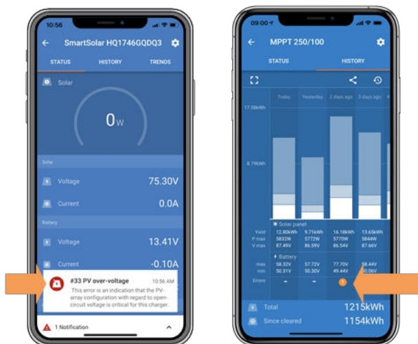
Victron Connect: snímka obrazovky s chybou č. 33 a snímka obrazovky s históriou označujúcou chybu
