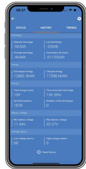
Aplicația VictronConnect afișând istoricul monitorului de baterie
