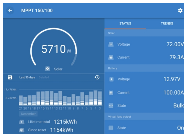
Captură de ecran a aplicației VictronConnect, care afișează date în timp real și date istorice.
