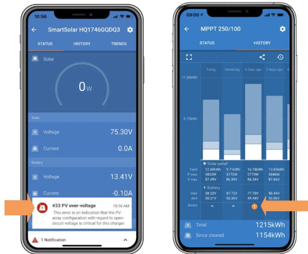
Afișarea erorii nr. 33 a aplicației VictronConnect pe ecranul de stare și pe ecranul de istoric.
