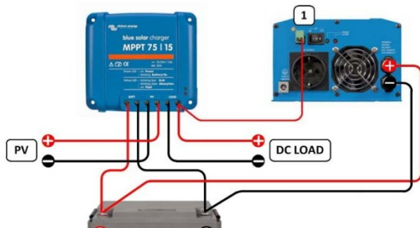
Figura 5: Invertoarele Victron modelele Phoenix 12/800, 24/800, 12/1200 și 24/1200 pot fi controlate prin conectarea conexiunii din partea dreaptă (1) a telecomenzii inverterului direct la ieșirea de sarcină a încărcătorului solar. În mod similar, toate invertoarele Phoenix VE.Direct pot fi controlate prin conectarea la conexiunea din partea stângă a telecomenzii
