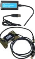
MK3-USB Rozhranie VE.Bus na USB Pripojenie k USB portu ( pozri „Príručka k VEConfigure“ )
