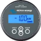
Monitor batérie BMV-700 Monitor batérie BMV-700 je vybavený pokročilým mikroprocesorovým riadiacim systémom v kombinácii s meracími systémami s vysokým rozlíšením pre napätie batérie a nabíjací/vybíjací prúd. Okrem toho softvér obsahuje komplexné výpočtové algoritmy, ako je Peukertov vzorec, na presné určenie stavu nabitia batérie. BMV-700 selektívne zobrazuje napätie batérie, prúd, spotrebované Ah alebo zostávajúci čas. Monitor tiež ukladá množstvo údajov týkajúcich sa výkonu a používania batérie.
