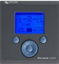
Blue Power Panel Pripojí sa k zariadeniam Multi alebo Quattro a ku všetkým zariadeniam VE.Net, najmä k regulátoru batérie VE.Net. Grafické zobrazenie prúdov a napätí.
