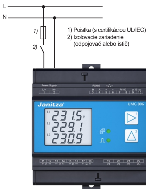
Obr. Pripojenie napájacieho napätia.
