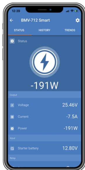
Obrazovka stavu v aplikácii VictronConnect pre monitor batérie pracujúci v režime merania jednosmerného prúdu.
