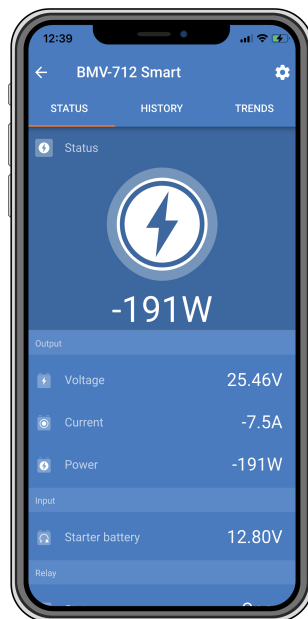
Ecraan de stare VictronConnect al unui monitor de baterie care funcționează în modul de monitorizare CC.
