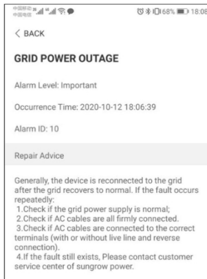
figura 7-9 Informații detaliate privind alarma de defecțiune
