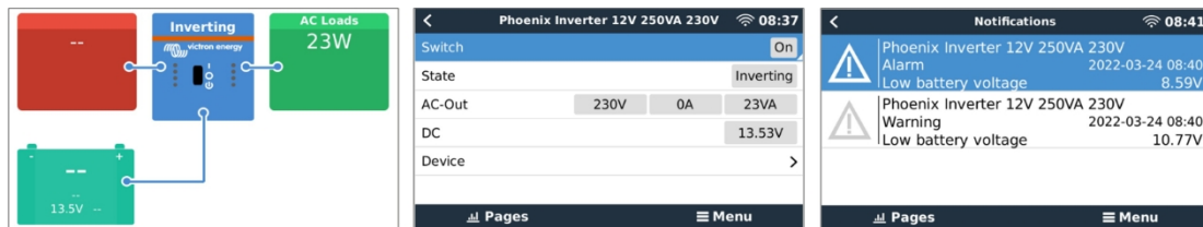
Beispiel für GX-Bildschirme von links nach rechts: Systembildschirm, Wechselrichtergeräteschirm und Alarmmeldung.
