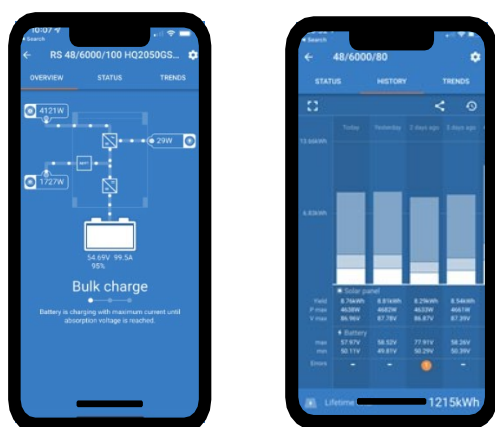
Konfigurácia a monitorovanie pomocou VictronConnect Vstavané Bluetooth Smart pripojenie umožňuje rýchle monitorovanie alebo nastavenie Multi RS.
