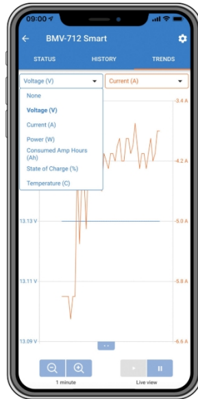
Tendințe de monitorizare a bateriei în aplicația VictronConnect.
