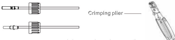
Obr. 3.4 Lisování kontaktního kolíku na vodič
