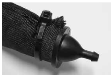
4. Pevně zatáhněte, v případě potřeby uřízněte
