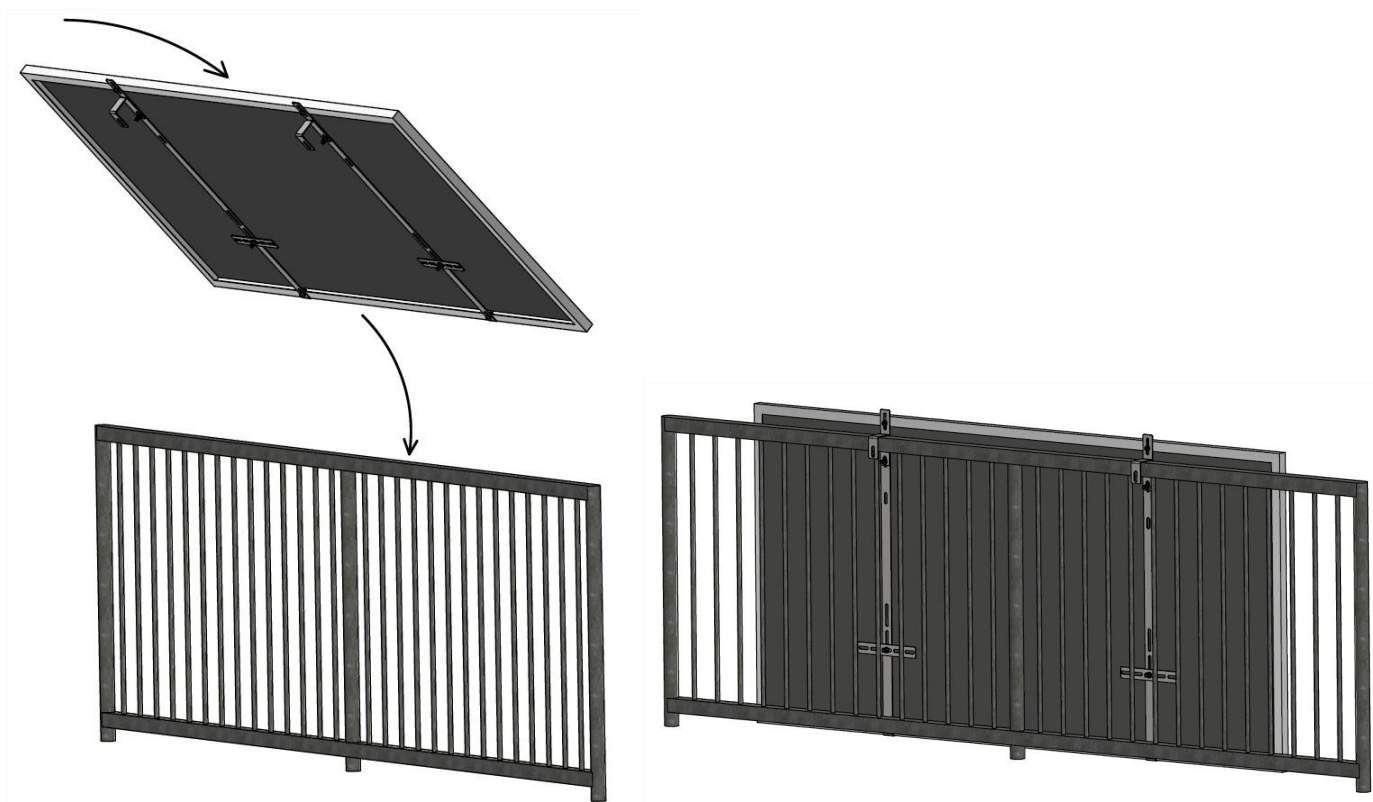
Abb. 7 Montage der Konstruktion am Geländer
