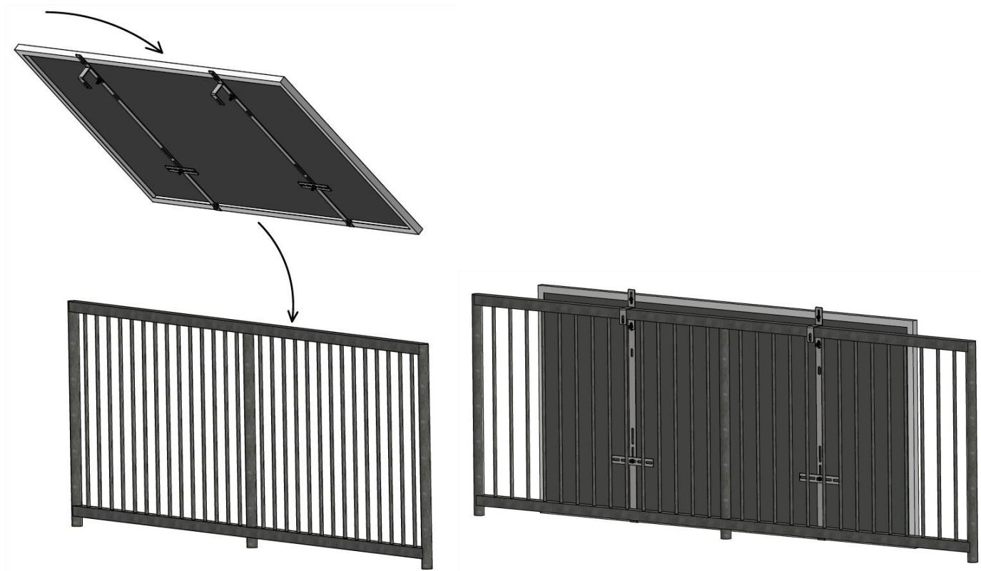
FIG.7 Instalarea structurii pe balustradă
