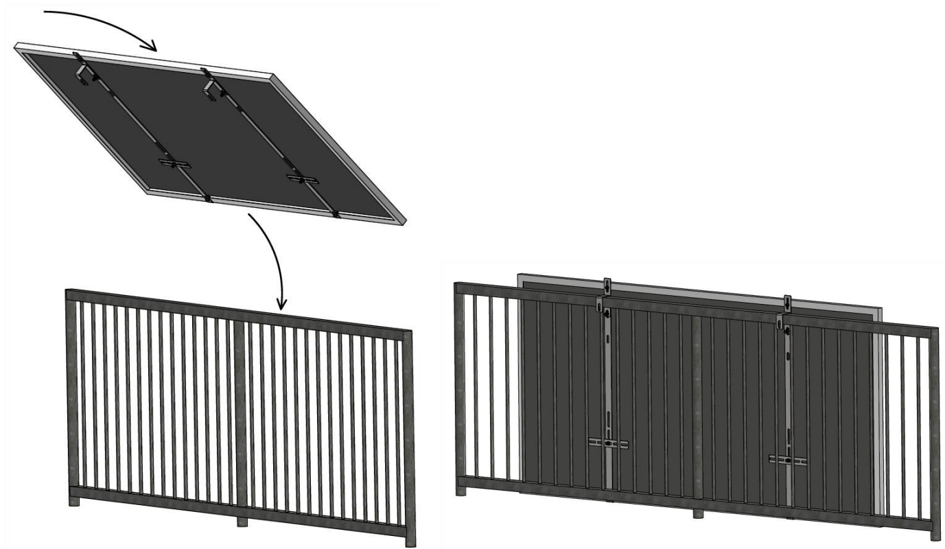
OBR. 7 Montáž konštrukcie na zábradlie
