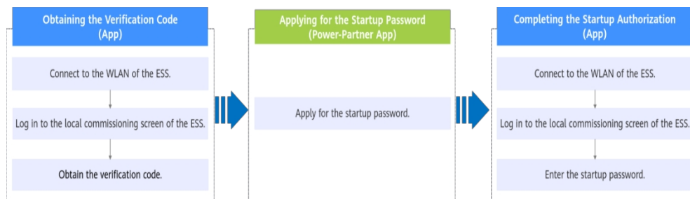
Abbildung 6-1 Verfahren zur Inbetriebnahmeautorisierung des ESS
